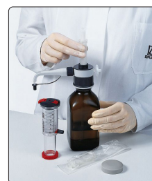
remplacement de l'unité de distribution
