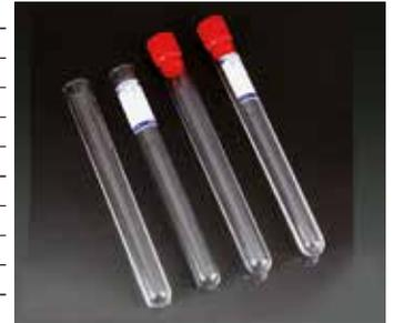
Tubes à fond conique avec rebord en polystyrène
