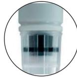
Contrôle optique : un joint d'étanchéité nettement saillant permet de contrôler que la pointe est correctement fixée
