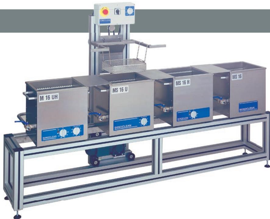
Le système se compose de 4 cuves de même capacité, placées en ligne sur un banc ou individuelles :
