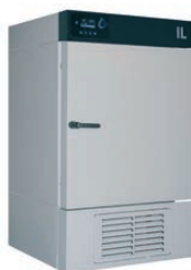
version standard : intérieur inox, extérieur acier peint
