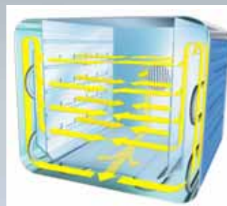
Refroidissement efficace, grâce aux grandes surfaces d'évaporation.
