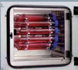
Le dispositif de rotation peut recevoir jusqu'à 12 flacons d'hybridation
