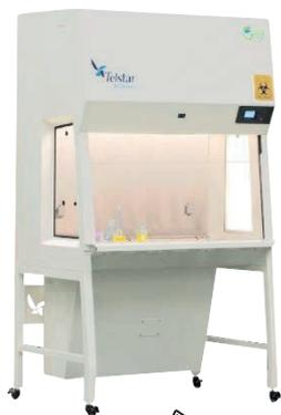
PSM Type II pour cytotoxiques avec filtres HEPA additionnels sous la surface de travail pour filtrer l'air d'arrivée et protéger de la contamination la partie interne du poste, augmentant ainsi la sécurité
