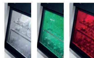
éclairage LED blanc, vert, rouge de la cuve, permet un contrôle rapide de l'avancée du processus
