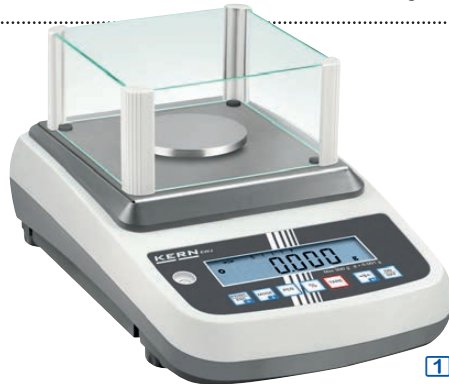
type A : 1 mg plateau Ø 118 mm dim. : 182 x p235 x h75 mm / 1,3 kg en option : chambre de protection en verre
