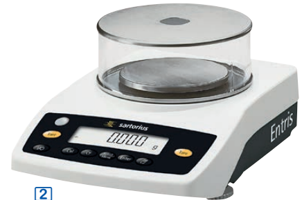
balances de précision, exactitude 1 mg, reproductibilité 1 mg, linéarité 2 mg plateau inox rond Ø 115 mm dimensions 230 x p303 x h136 mm
