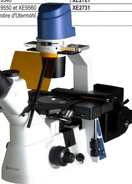
modèle 4 positions livré avec 3 blocs de filtration standard pour l'excitation : spectre bleu (EX465-495 nm / EM515-558 nm) spectre vert (EX520-600 nm / EM605-665 nm) et spectre UV (EX361-381 nm / EM435-495 nm)
