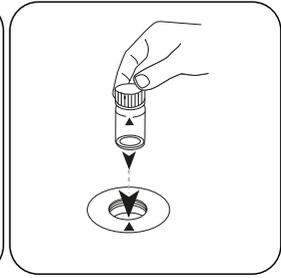
Placez la **cuvette** Chloramine dans la chambre de mesure. Attention à la positionner correctement.
