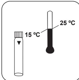
Laissez refroidir l'échantillon à **température ambiante**.
