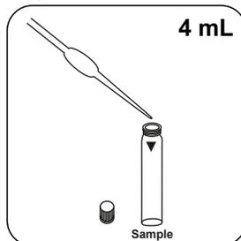
Versez **4 mL d'échantillon** dans la cuvette réservée à l'échantillon.
