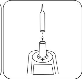
Retirez l'ampoule du blanc de la chambre de mesure.
