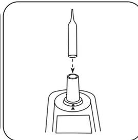
Placez l'ampoule dans la chambre de mesure.
