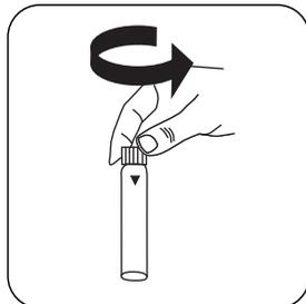
Ouvrez la **cuvette de réactif Phosphate Dilution**.
