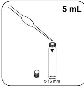
Versez **5 mL d'échantillon** dans la cuvette de fractionnement.
