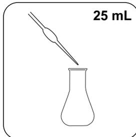
Versez **25 mL d'échantillon** dans le tube de fractionnement.
