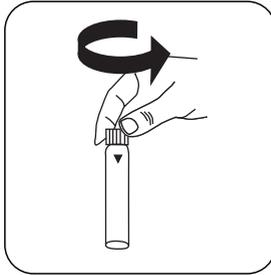
Ouvrez une **cuvette de réactif** .
