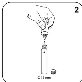
Dans chaque cuvette, versez **2 gouttes de solution Reagenz T-1 K**.
