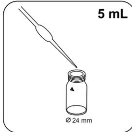
Versez **5 mL d'échantillon** et **5 mL d'eau déminéralisée** dans la cuvette d'échantillonnage.
