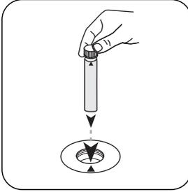
Placez la **cuvette prétraitée** dans la chambre de mesure. Attention à la positionner correctement.
