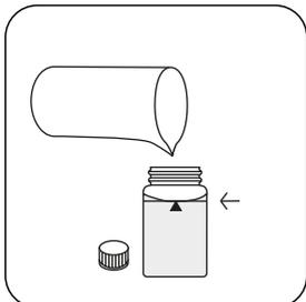
Remplissez la cuvette jusqu'au **repère de 10 mL** en y versant l'échantillon.
