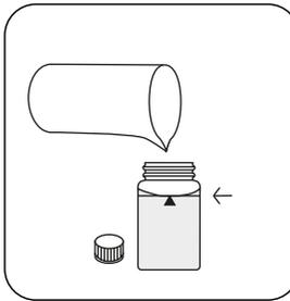
Remplissez la cuvette jusqu'au **repère de 10 mL** en y versant l'**échantillon**.
