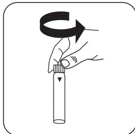
Ouvrez une cuvette de fractionnement **PO<sub>4</sub>-P Acid Reagent**.
