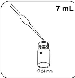
Remplissez une cuvette de 24 mm de **7 mL d'eau déminéralisée**.
