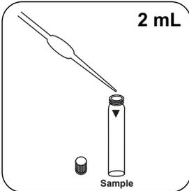
Versez **2 mL d'échantillon fractionné, préparé** dans la cuvette réservée à l'échantillon.
