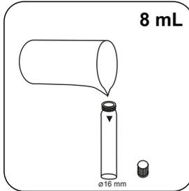
Remplissez une cuvette de 16 mm de **8 mL d'échantillon**.
