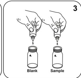
Dans chaque cuvette, versez **3 gouttes de solution Chloride-51**.
