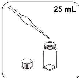
Remplissez une cuvette de fractionnement avec **25 mL d'échantillon préparé**.
