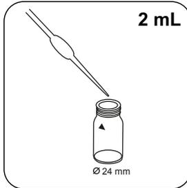
Versez **2 mL d'échantillon** et **8 mL d'eau déminéralisée** dans la cuvette d'échantillonnage.
