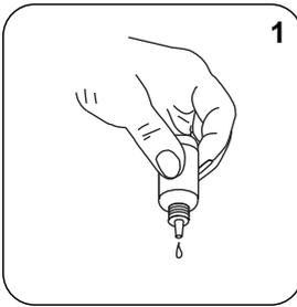
Ajoutez **1 goutte de KS135 (Phenolphthalein Substitute Indikator)**.
