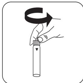
Ouvrez la **cuvette de réactif** .
