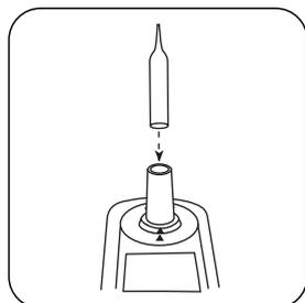
Placez l'ampoule dans la chambre de mesure.
