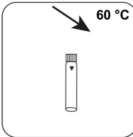
Laissez la(les) cuvette(s) refroidir à env. 60 °C.
