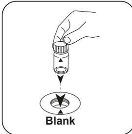
Placez la **cuvette du blanc** dans la chambre de mesure. Attention à la positionner correctement.
