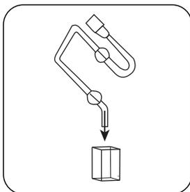
Remplissez la cuvette de 20 mm en y versant la solution absorbante colorée.
