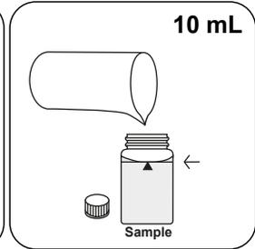
Versez **10 mL d'échantillon** dans la cuvette réservée à l'échantillon.
