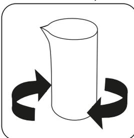
Mettez le tube de fractionnement plusieurs fois à l'envers et laissez-le refroidir à température ambiante.
