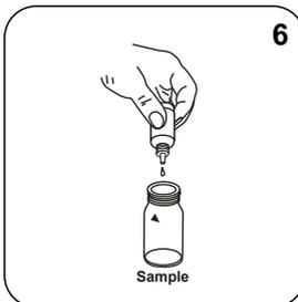
Ajoutez **6 gouttes de DPD 1 Buffer Solution** dans la cuvette réservée à l'échantillon.
