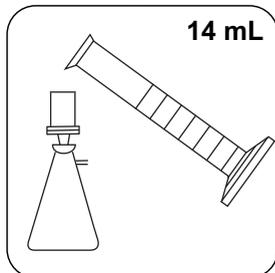
Filtrez environ 14 mL d'échantillon avec un filtre prélavé (taille des pores 0,45  $\mu\text{m}$ ).
