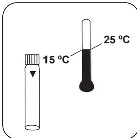
Laissez d'abord refroidir la cuvette à température ambiante puis effectuez les mesures.
