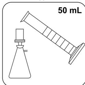
Filtrez environ 50 mL d'échantillon avec un filtre prélavé (taille des pores 0,45 µm).
