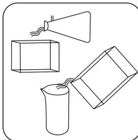
Remplissez la cuvette en y versant l'échantillon préparé.
