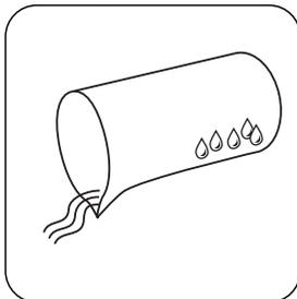
Lavez un tube pour échantillon adéquat **avec un peu d'échantillon et videz-le en laissant quelques gouttes.**
