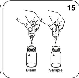
Dans chaque cuvette, versez **15 gouttes de solution Vario Molybdate 3 Reagent**.
