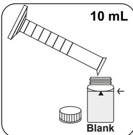
Versez **10 mL d'échantillon préparé, non fractionné** dans la cuvette du blanc.
