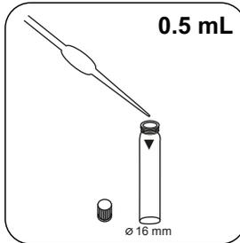
Versez **0.5 mL d'échantillon** dans la cuvette de fractionnement.
