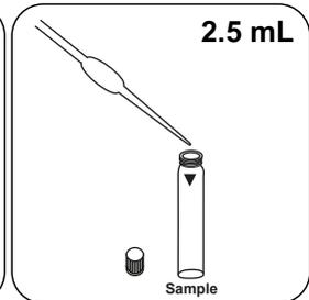
Versez **2.5 mL d'échantillon** dans la cuvette réservée à l'échantillon.
