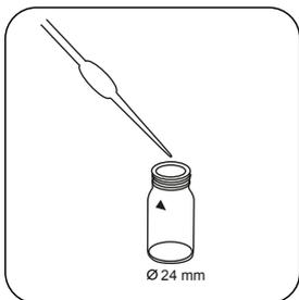
Versez dans la cuvette quelques gouttes d'échantillon.
