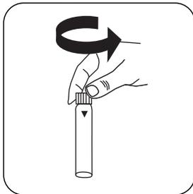
Ouvrez une **cuvette de réactif** .
