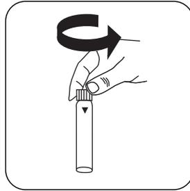
Ouvrez la **cuvette réservée** à l'échantillon.
