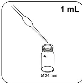
Ajoutez **1 mL de solution (25 Tropfen) KS256 (Polyacrylate Reagenz 2)** dans la cuvette réservée à l'échantillon.
