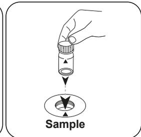
Remplissez une cuvette de 24 mm de **10 mL d'échantillon**.
