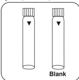
Préparez deux **cuvettes TN Acid LR/HR (Reagent C)**. L'une des deux cuvettes sera la cuvette du blanc. Étiquetez-la.
