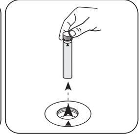
Ré retirez la **cuvette** de la chambre de mesure.
