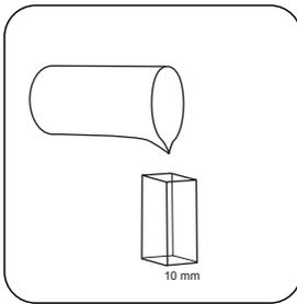
Remplissez une **cuvette de 10 mm** en y versant l'échantillon.
