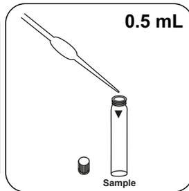
Versez **0.5 mL d'échantillon fractionné, préparé** dans la cuvette réservée à l'échantillon.
