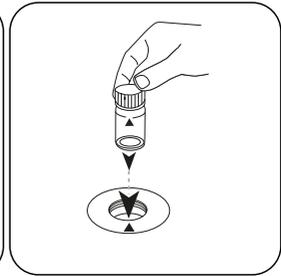
Placez la **cuvette** Ammonia dans la chambre de mesure. Attention à la positionner correctement.
