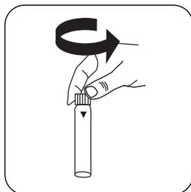
Ouvrez la cuvette réservée à l'échantillon.
