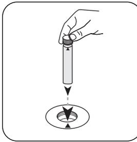
Placez la **cuvette du blanc** dans la chambre de mesure. Attention à la positionner correctement.
