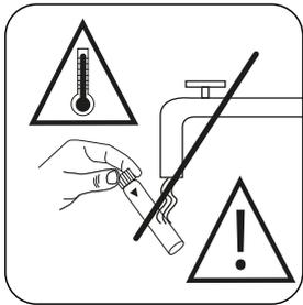
Laissez refroidir la cuvette à l'envers pendant 1 heure. **Ne pas refroidir à l'eau !** Après le refroidissement, mettez la cuvette à l'en-droit et mesurez-la dans le photomètre **dans les 10 min qui suivent.**
