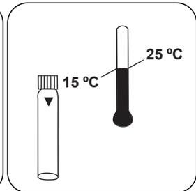
Laissez la(les) cuvette(s) refroidir à température ambiante.
