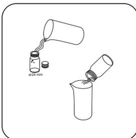
Prélevez la cuvette avec l'échantillon d'eau.
