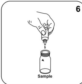
Ajoutez **6 gouttes de PHENOL Red-Lösung** dans la cuvette réservée à l'échantillon.
