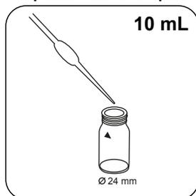
Remplissez une cuvette de 24 mm avec une **quantité exacte de 10 mL d'échantillon**.
