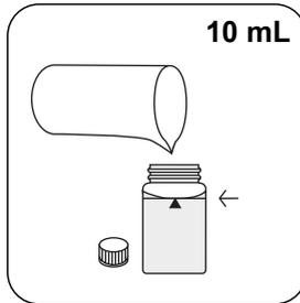
Ajoutez **10 mL de solution Nitrite VHR L** dans la cuvette réservée à l'échantillon.
