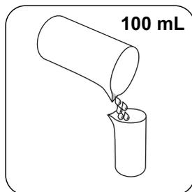
Versez **100 mL d'échantillon** dans un tube pour échantillon adéquat.
