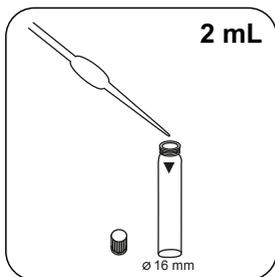
Ajoutez **2 mL 1,54 N solution d'hydroxyde de sodium** de l'échantillon fractionné.
