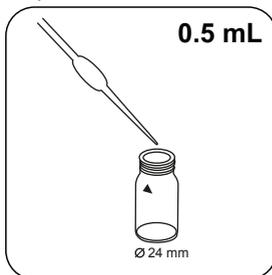
Ajoutez **0.5 mL de solution Molybdenum 2 LR** dans la cuvette réservée à l'échantillon.
