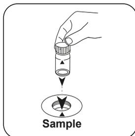
Placez la **cuvette réservée à l'échantillon** dans la chambre de mesure. Attention à la positionner correctement.
