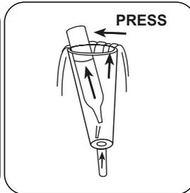
Placez une ampoule Vacu-vial® dans le tube de réactif. Brisez la pointe de l'ampoule en pressant légèrement contre la paroi du tube. Patientez jusqu'à ce que l'ampoule soit pleine.
