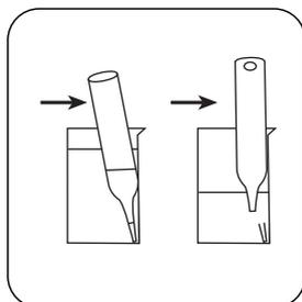
Placez une ampoule Vacu-vial® dans le tube pour échantillon. Brisez la pointe de l'ampoule en pressant légèrement contre la paroi du tube. Patientez jusqu'à ce que l'ampoule soit pleine.
