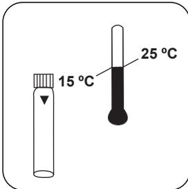
Laissez refroidir l'échan-tillon à **température ambiante**.
