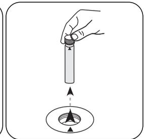
Retirez la **cuvette** de la chambre de mesure.
