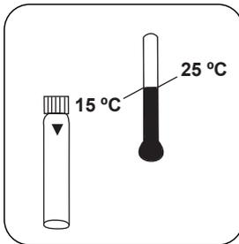
Laissez refroidir l'échantillon à **température ambiante**.
