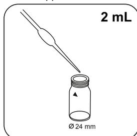
Dans la cuvette de 24 mm, versez une **quantité exacte de 2 mL SPADNS reagent solution**.
