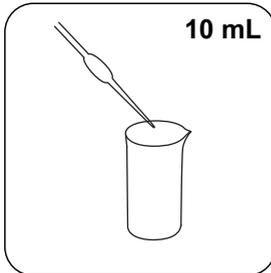
Verser **10 mL d'échantillon** dans un tube pour échantillon adéquat.
