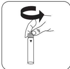
Ouvrez une **cuvette de réactif**.
