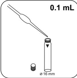
Ajoutez **0.1 mL (2 gouttes) Phosphate-101** de l'échantillon fractionné.
