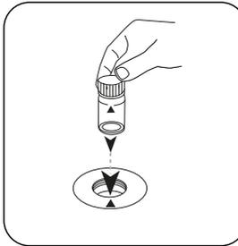
Placez la **cuvette** Chlore dans la chambre de mesure. Attention à la positionner correctement.
