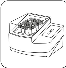
Fractionnez la(les) cuvette(s) dans un thermoréacteur préchauffé pendant **60 minutes à 100 °C**.
