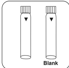
Préparez deux **cuvettes de réactif**. L'une des deux cuvettes sera la cuvette du blanc. Étiquetez-la.
