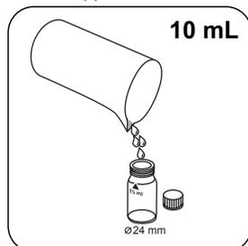
Rempissez une cuvette de 24 mm de **10 mL d'échantillon préparé**.
