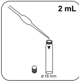
Ajoutez **2 mL 1,00 N Sodium Hydroxide solution** de l'échantillon fractionné.
