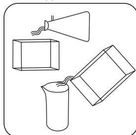
Prélevez la cuvette avec l'échantillon d'eau.
