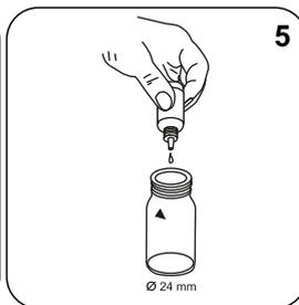
Ajoutez **5 gouttes de Free Chlorine Reagent Solution** dans la cuvette **Chlore**.
