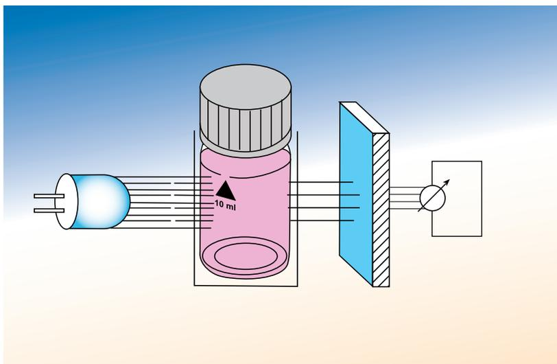
La transmittance d'un matériau est la fraction de l'intensité lumineuse le traversant. C'est le rapport entre l'intensité incidente ( $I_0$ ) et l'intensité sortante ( $I$ ). Pour représenter l'absorbance de la lumière sur une grande plage de fréquences, on choisit généralement le logarithme négatif de base dix de la transmittance, désigné également d'extinction.
