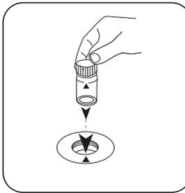
Placez la **cuvette** Chloramine dans la chambre de mesure. Attention à la positionner correctement.
