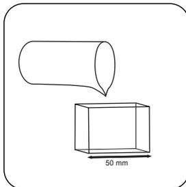
Remplissez une **cuvette de 50 mm** en y versant l'**échantillon**.
