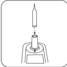
Placez l'**ampoule du blanc** dans la chambre de mesure.
