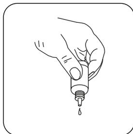
Ajoutez au goutte à goutte **KS 144 (tampon de dureté calcique)** au même échantillon jusqu'à obtention d'une coloration rosée à rouge. (**Attention : agitez l'échantillon après chaque goutte ajoutée !**)
