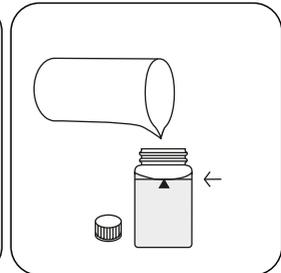
Remplissez la cuvette jusqu'au **repère de 10 mL** en y versant l'échantillon.
