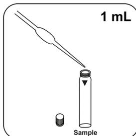
Versez **1 mL d'échantillon** dans la cuvette réservée à l'échantillon.
