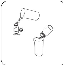
Prélevez la cuvette avec l'échantillon d'eau.
