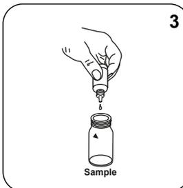
Ajoutez **3 gouttes de Ca Mg Hardness SOL 1 (bouteille rouge)** dans la cuvette réservée à l'échantillon.
