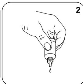
Ajoutez **2 gouttes de KS135 (Phenolphthalein Substitute Indikator)**.
