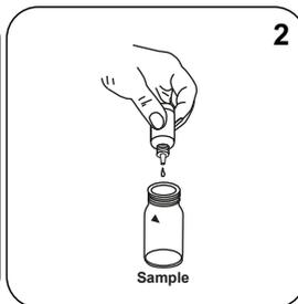
Ajoutez **2 gouttes de DPD 1 Reagent Solution** dans la cuvette réservée à l'échantillon.
