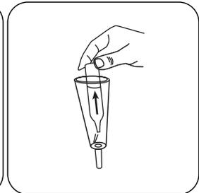
Ensuite, retirez rapidement l'ampoule pleine du tube de réactif, en dirigeant la pointe vers le bas.
