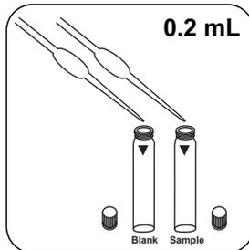
Dans chaque cuvette, versez **0.2 mL de solution Réactif Cd-1K**.
