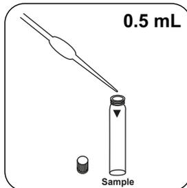
Versez **0.5 mL d'échantillon** dans la cuvette réservée à l'échantillon.
