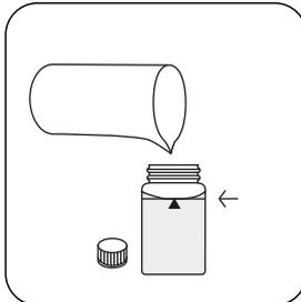
Rempissez la cuvette jusqu'au **repère de 10 mL** en y versant l'échantillon.
