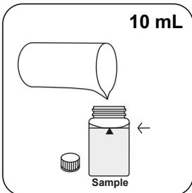
Versez **10 mL d'échantillon fractionné, préparé** dans la cuvette réservée à l'échantillon.
