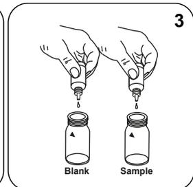
Dans chaque cuvette, versez **3 gouttes de solution Chloride-52**.
