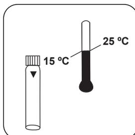
Laissez la(les) cuvette(s) refroidir à température ambiante.
