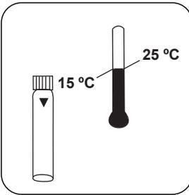
Laissez refroidir l'échantillon à **température ambiante**.
