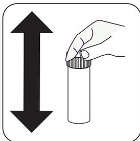
Fermez le tube à essai à l'aide du couvercle et mélangez le contenu en agitant fortement pendant 1 minute.
