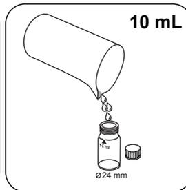
Remplissez une cuvette de 24 mm de **10 mL d'échantillon préparé**.
