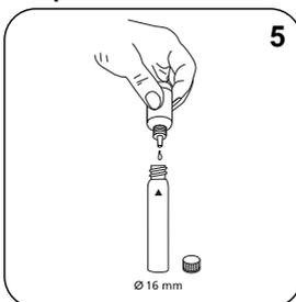
Dans chaque cuvette, versez **5 gouttes de solution Reagenz Pb-1K**.
