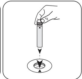
Placez la **cuvette réservée à l'échantillon** dans la chambre de mesure. Attention à la positionner correctement.
