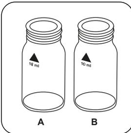
Préparez deux cuvettes propres de Ammoniac mm. L'une des deux cuvettes sera la cuvette du blanc. Étiquetez-la.
