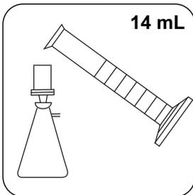
Filtrez environ 14 mL d'échantillon avec un filtre prélavé (taille des pores 0,45 µm).
