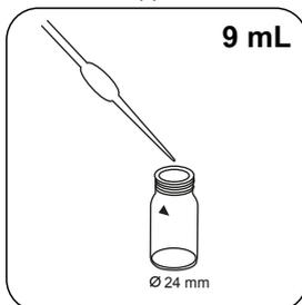
Remplissez une cuvette de 24 mm de **9 mL d'eau déminéralisée**.
