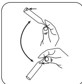
Mettez l'ampoule plusieurs fois à l'envers de manière à ce que la bulle d'air passe d'une extrémité à l'autre. Ensuite, séchez de l'extérieur.
