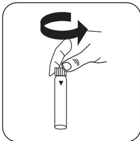
Ouvrez **une cuvette de réactif** .
