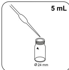
Remplissez une cuvette de 24 mm de **5 mL d'eau déminéralisée**.
