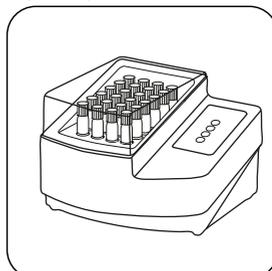
Fractionnez la(les) cuvette(s) dans un ther-moréacteur préchauffé pendant **30 minutes à 100 °C**.
