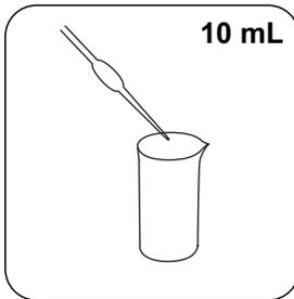
Versez **10 mL d'échantillon** dans le tube de fractionnement.
