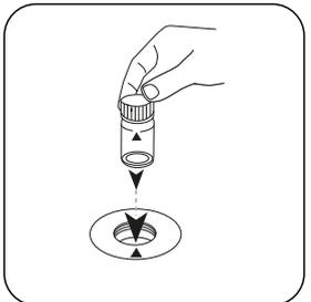
Placez la **cuvette** Chlore dans la chambre de mesure. Attention à la positionner correctement.
