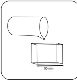
Remplissez une **cuvette de 50 mm** en y versant l'**échantillon**.
