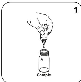
Ajoutez **1 goutte de Ca Mg Hardness SOL 4 (bouteille blanche)** dans la cuvette réservée à l'échantillon.
