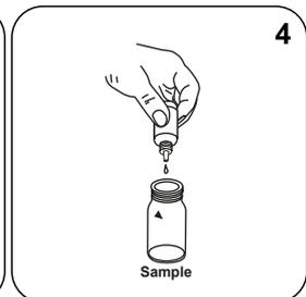
Ajoutez **4 gouttes de Ca Mg Hardness SOL 2 (bouteille bleue)** dans la cuvette réservée à l'échantillon.
