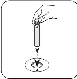
Placez la cuvette du blanc fourni (autocollant rouge) dans la chambre de mesure. Attention à la positionner correctement.
