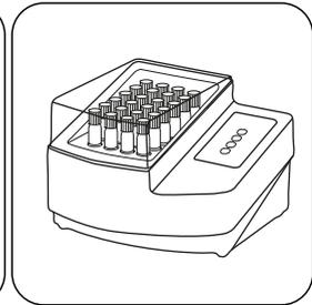
Fractionnez la(les) cuvette(s) dans un ther-moréacteur préchauffé pendant **60 minutes à 100 °C**.
