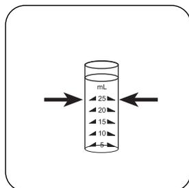
Remplissez le tube d'échantillon jusqu'au repère de 25 mL d'échantillon.
