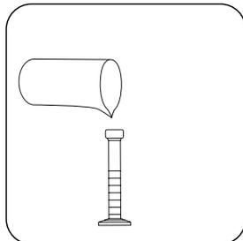
Remplissez une fiole volumétrique de 50 mL du volume d'échantillon sélectionné. Si nécessaire, rajoutez de l'eau déminéralisée pour obtenir 50 mL et mélangez.
