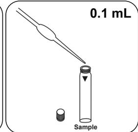
Versez **0.1 mL d'échantillon** dans la cuvette réservée à l'échantillon.
