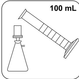
Filtrez environ 100 mL d'échantillon avec un filtre prélavé (taille des pores 0,45 µm).
