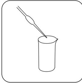
Dans le tube pour échantillon, versez **2 mL d'échantillon et 8 mL d'eau déminéralisée**.
