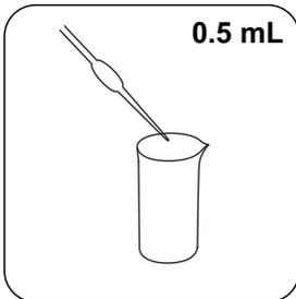
Dans un tube pour échantillon adéquat, versez **0.5 mL de Reagent Pb-1**.
