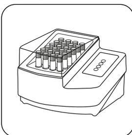
Fractionnez la(les) cuvette(s) dans un thermoréacteur préchauffé pendant **120 minutes à 100 °C**.
