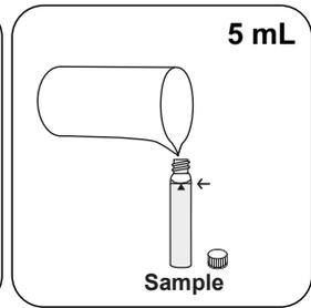
Versez **5 mL d'échantillon** dans la cuvette réservée à l'échantillon.
