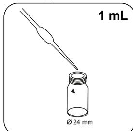
Ajoutez **1 mL de solution (25 Troupfen) KS255 (Polyacrylate Reagenz 1)** dans la cuvette réservée à l'échantillon.
