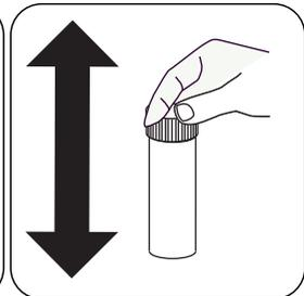
Fermez le tube à essai à l'aide du couvercle et mélangez le contenu en agitant fortement pendant 1 minute.
