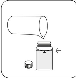
Remplissez la cuvette jusqu'au **repère de 10 mL** en y versant l'**eau déminéralisée**.
