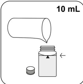
Remplissez une cuvette de 24 mm de **10 mL d'eau déminéralisée**.
