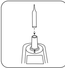
Placez l'ampoule dans la chambre de mesure.
