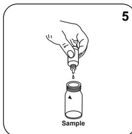
Ajoutez **5 gouttes de Free Chlorine Reagent Solution** dans la cuvette réservée à l'échantillon.
