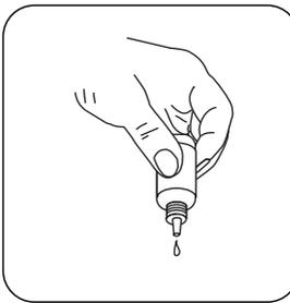
Ajoutez au goutte à goutte **KS 144 (tampon de dureté calcique)** au même échantillon jusqu'à obtention d'une coloration rosée à rouge. (**Attention : agitez l'échantillon après chaque goutte ajoutée !**)
