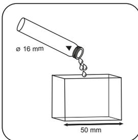
Remplissez la cuvette de 50 mm de l'échantillon préparé.
