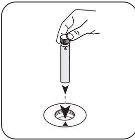
Placez la cuvette du blanc fourni (autocollant rouge) dans la chambre de mesure. Attention à la positionner correctement.
