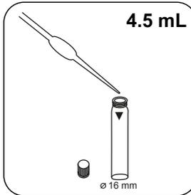
Versez **4.5 mL d'eau déminéralisée** dans la cuvette de fractionnement.
