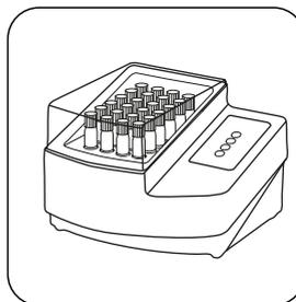
Réchauffez la cuvette pendant **120 minutes à 120 °C** dans le thermo-réacteur préchauffé **après l'avoir mis à l'envers**.
