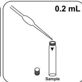
Versez **0.2 mL d'échantillon** dans la cuvette réservée à l'échantillon.
