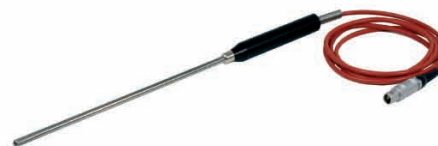
FP105 thermosonde externe pour régulation précise du milieu à thermostat
