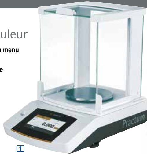
Balance analytique 0,1 mg, plateau inox rond Ø 90 mm, vitrines coulissantes, hauteur de la chambre de pesée 209 mm paravent robuste démontable, lavable en lave-vaisselle
